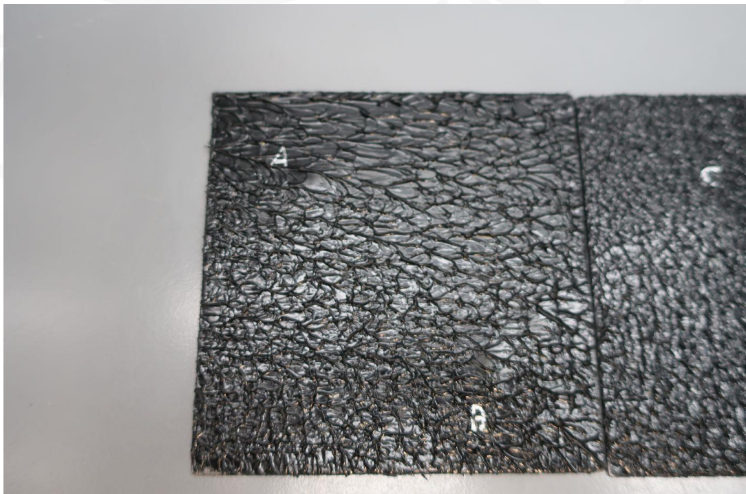
Abbildung 9: Prüfling1 aus 3.2 – Prüfseite nach dem Schlagtest
