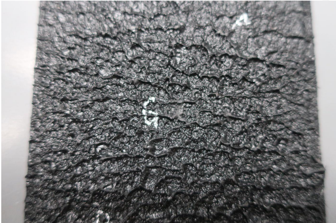
Abbildung 20: Prüfling 1 aus 3.3 - Prüfseite nach Belastung
