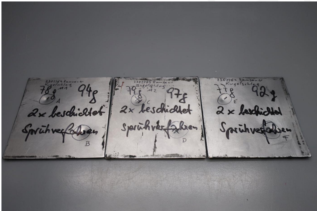
Abbildung 10: Prüflinge 3.3 - 2x gesprüht
